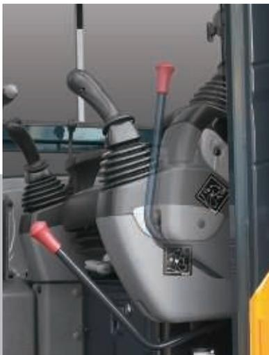
Die klappbare linke Konsole erleichtert dem Fahrer Ein- und Ausstieg.
